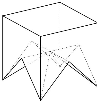
**Primjer 3.** Geometrijsko tijelo (figuru) prikazano projekcijama (tlocrt, nacrt i bokocrt), nacrtajmo u kosoj projekciji.
