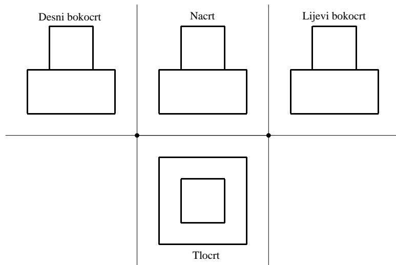
**Zadatak 1.** Na idućim su slikama geometrijske figure prikazane u kosoj projekciji. Nacrtajte projekcije tlocrta, nacrta i bokocrta (lijevi i desni) za svaku od figura.
